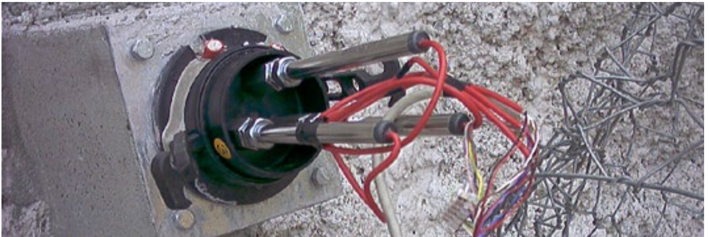
Cabezal MPBX con transductores de desplazamiento, instalado en un muro de contención
